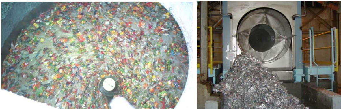
Figuras 5 e 6: Desagregação de ECAL à alta consistência e separação de poli-al utilizando-se tambor lavador
